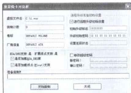
图五 批量烧制时设置初始标志和密码
